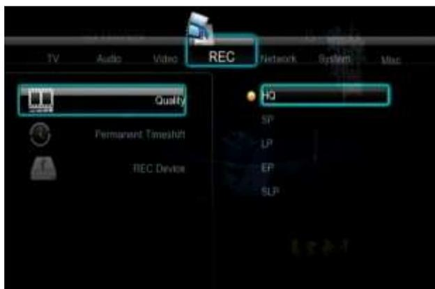
Pulse arriba o abajo para seleccionar la configuración de calidad que requiera. La configuración de calidad más alta es HQ que requiere la máxima capacidad de almacenamiento. Las otras configuraciones reducen la calidad de grabación de forma secuencial pero también requieren menos capacidad de almacenamiento. Pulse entrar para confirmar.
