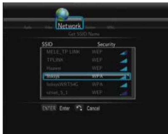
Pulse Enter para ir al siguiente paso, Return para cancelar y Select para refrescar la lista SSID. Nota: En la lista de seguridad, WEP (Wired Equivalent Privacy) y WPA (Wi-Fi Protected Access) significan que la red esta encriptada, por lo que para acceder a la red será necesaria una clave de acceso. No es un sistema de red abierto.
